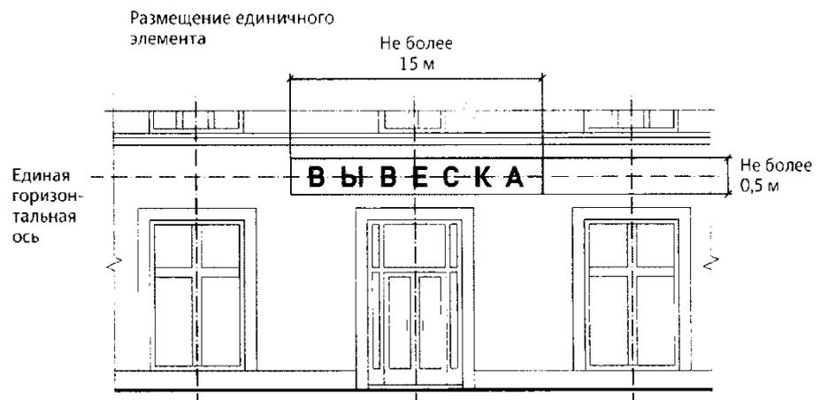
3) крайняя точка элементов настенной конструкции не должна находиться на расстоянии более чем 0,20 м от плоскости фасада:
